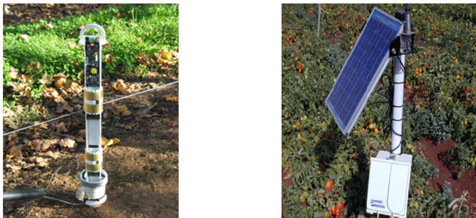
Figura 3. Multisonda enviroSCAN e sistema automático de colata de dados. Foto: ( http://www.sentek.com.au )
