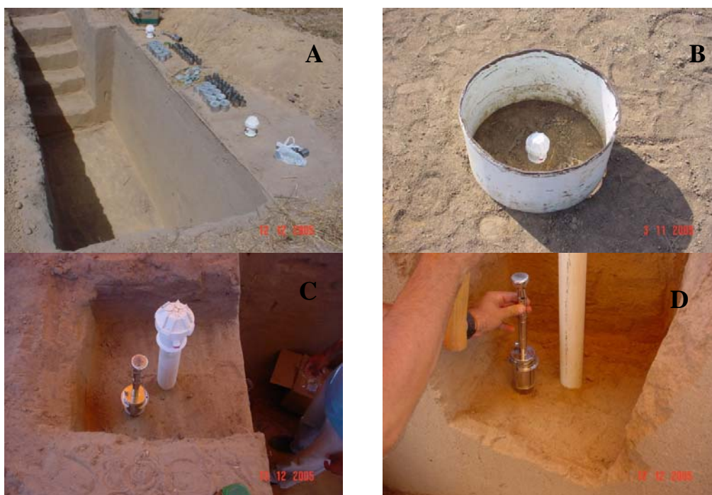
Figura 9. Trincheira aberta próxima aos tubos de acesso (A). Anel de infiltração utilizado para umedecer o solo próximo ao tubo e em profundidade (B). Posição do amostrador tipo Uhland para retirada das amostras indeformadas (C) e (D).
